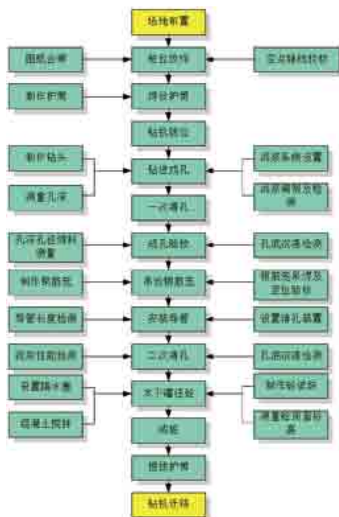
图1 混凝土灌注桩施工顺序及流程
